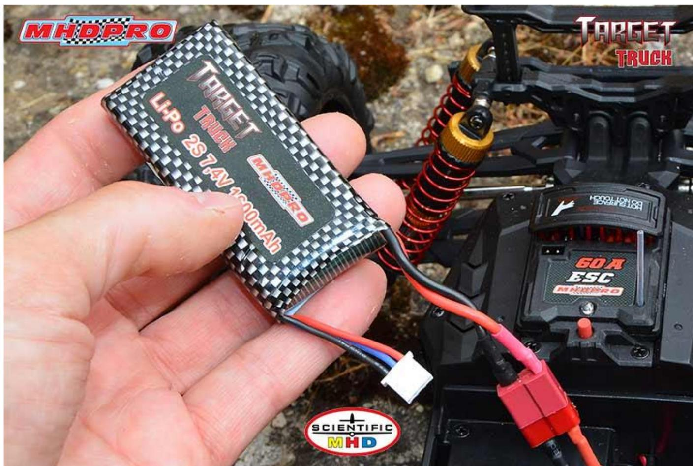
L'accu livré avec l'auto est un Li-Po 2S de 7,4 volts de 1600 mA. Il est équipé d'une prise Dean et d'une prise d'équilibrage pour préserver les éléments durant la charge.
