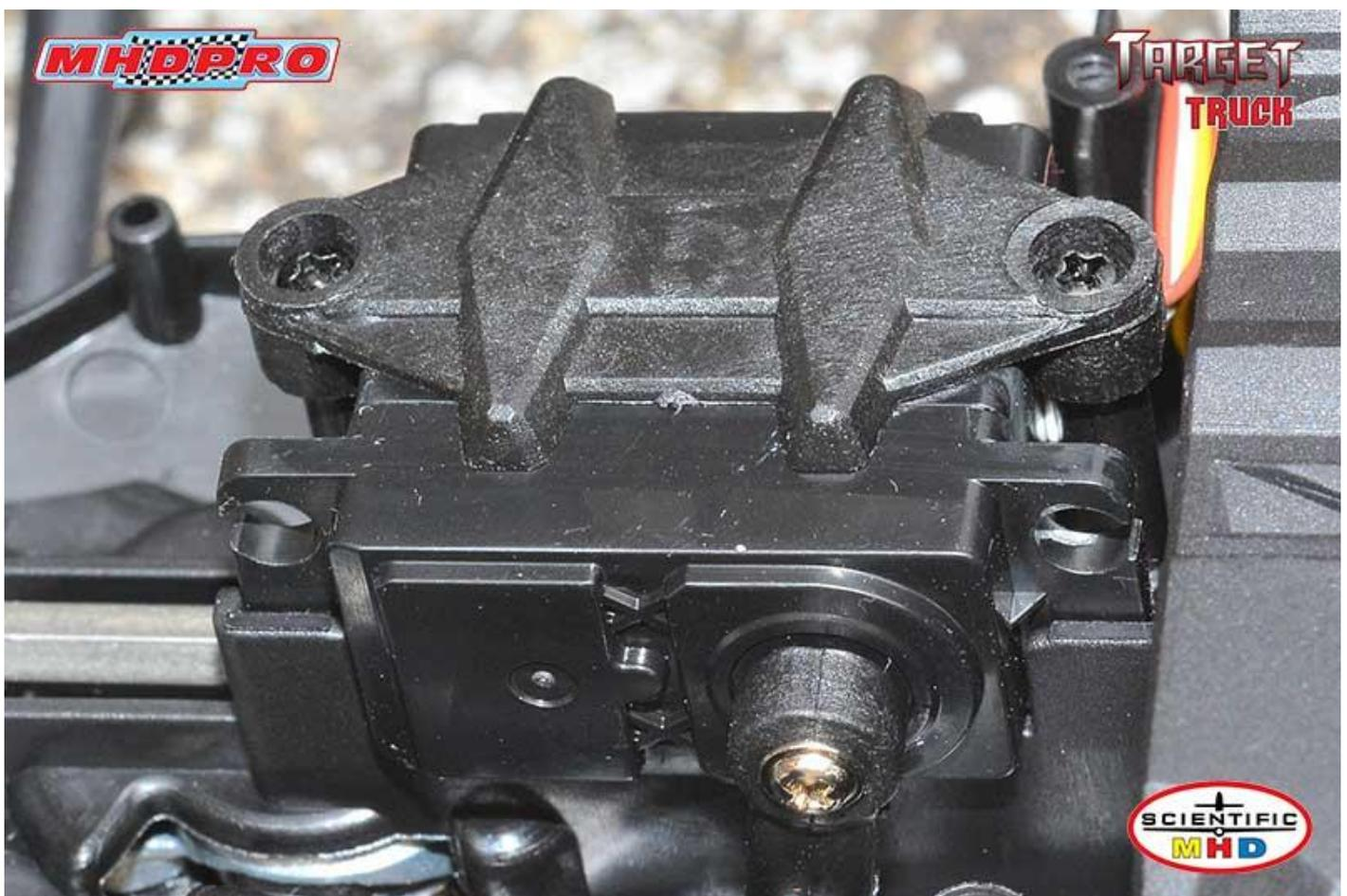
Le servo délivre 2,2 kilos de couple aux roues. Il est équipé de pignons en plastique.
