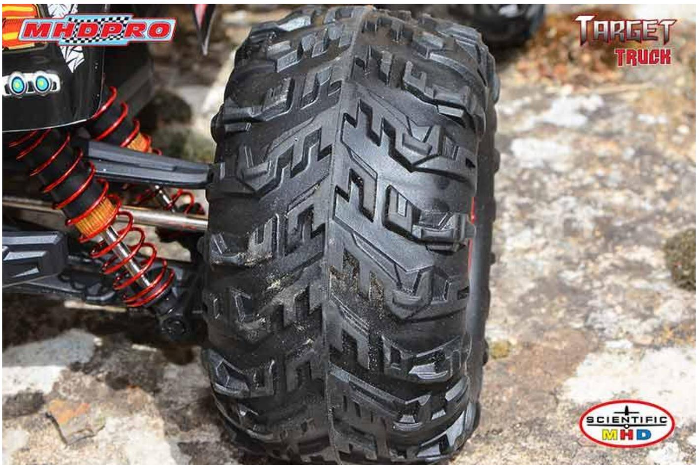
Les pneus du Target sont moussés et mesurent 11 cm de haut sur 6 cm de large.
