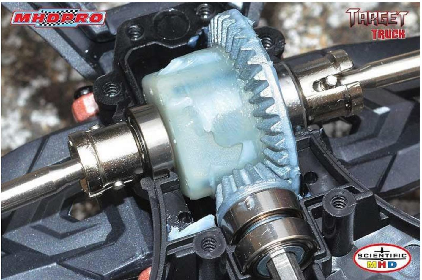
Les couples de transmission sont métalliques et parfaitement calés d'origine. Relevez la transmission montée sur roulements à billes. Rarissime sur un engin premier prix !
