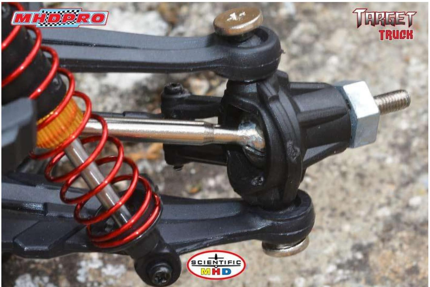
Les porte fusées avant sont montés sur rotules.
