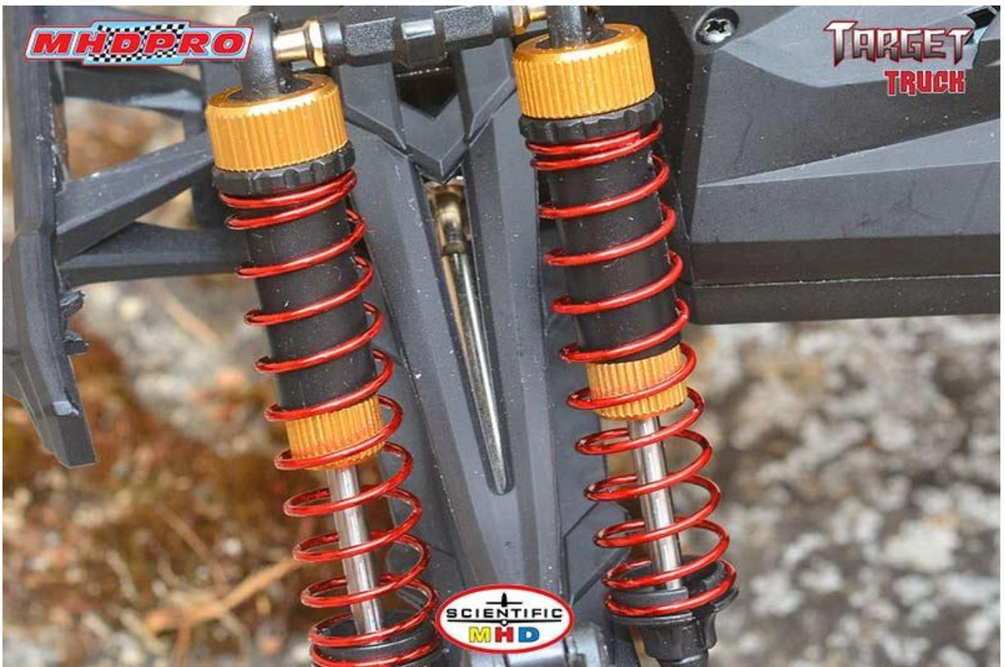
La suspension arrière se dote de 2 amortisseurs hydrauliques par roue. D'où une hydraulique plus constante sur la durée d'utilisation, et par fortes chaleurs.
