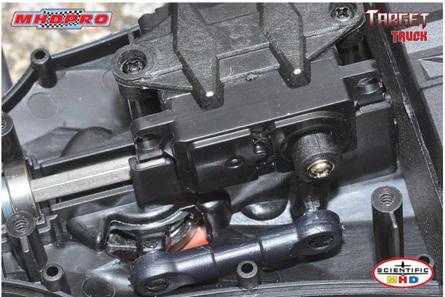
Le Target MhdPro pourra compter sur la présence d'un vrai servo à la direction.
