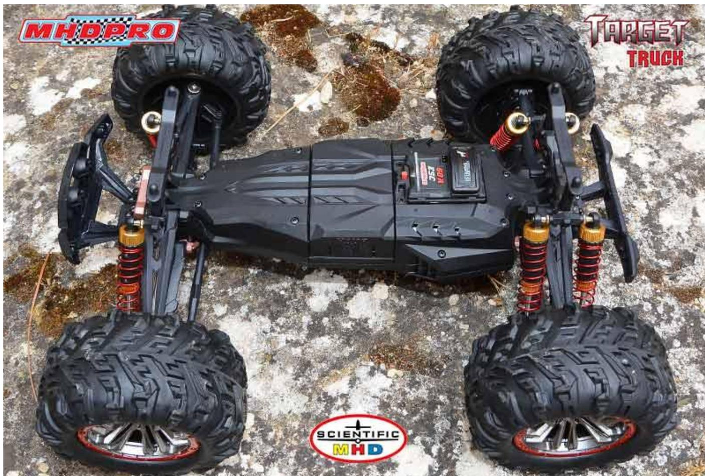
Sur le dessus, le châssis comporte 2 parties vissées qui abritent la majeure partie de la mécanique, dont les moteurs et le servo de direction.
