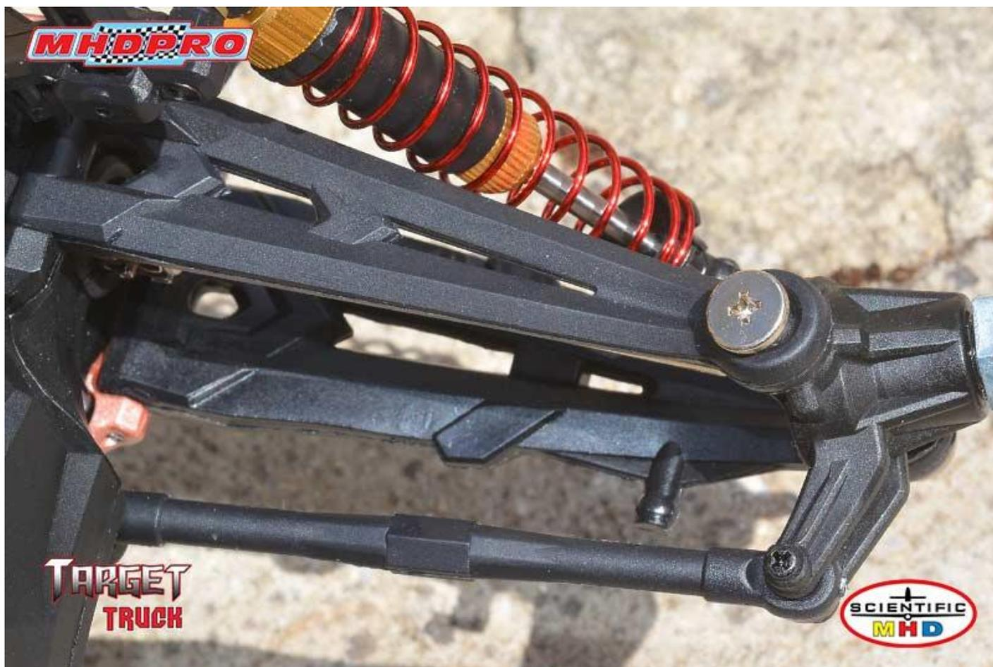
La géométrie avant repose sur une double triangulation.
