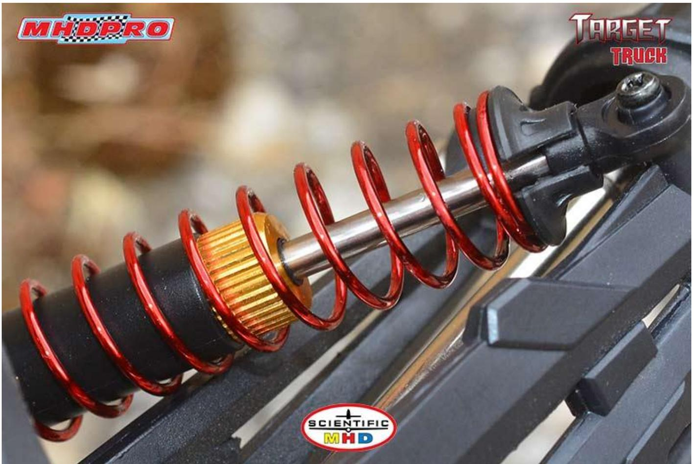
Les bouchons inférieurs qui contiennent les joints du système d'étanchéité des amortisseurs sont également en aluminium anodisé.
