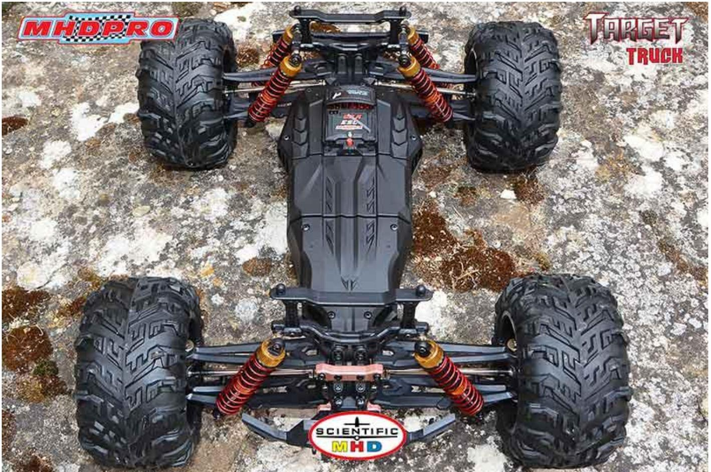
Le châssis forme une sorte de caisson hermétique. Il est fabriqué à partir de plastique injecté.
