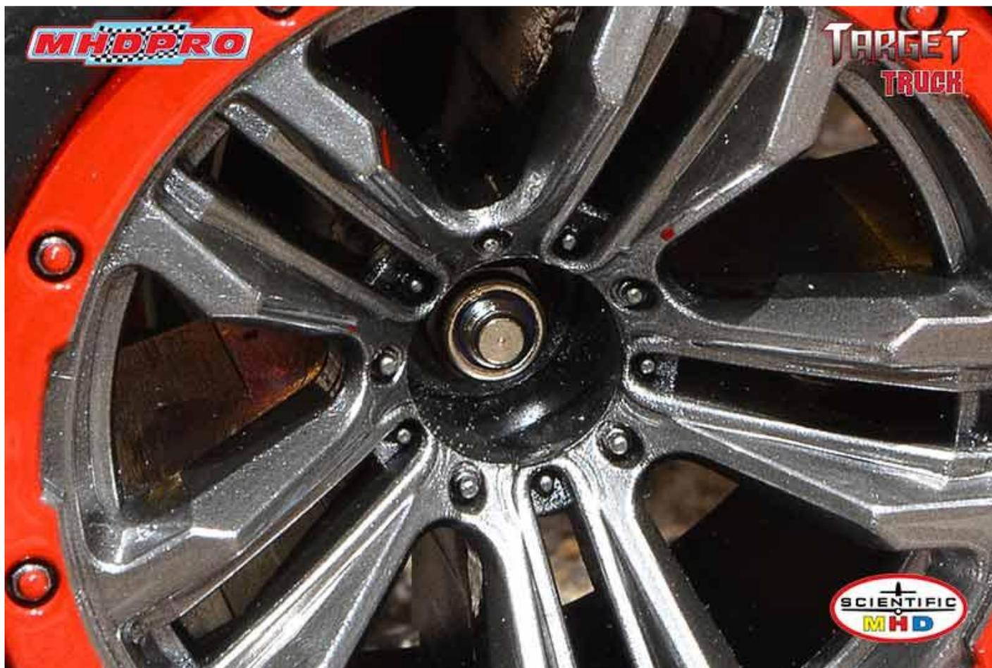
Encore une bonne nouvelle rarissime pour un engin de cette échelle : la fixation des pneus est confiée à des écrous nylostop de 7 mm de diamètre, et non à des vis. C'est beaucoup plus fiable !
