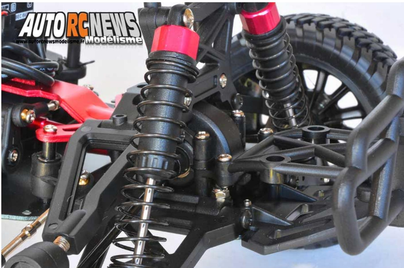
**Les amortisseurs hydrauliques à corps plastiques remplissent correctement leur rôle.**
