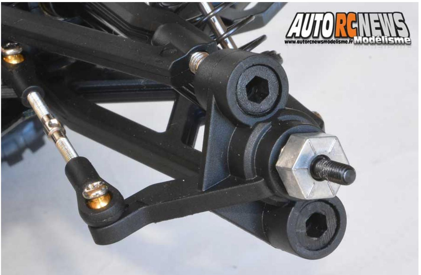
**Sur les côtés des porte fusées, deux vis BTR permettent de modifier la largeur du train ou le carrossage des roues.**
