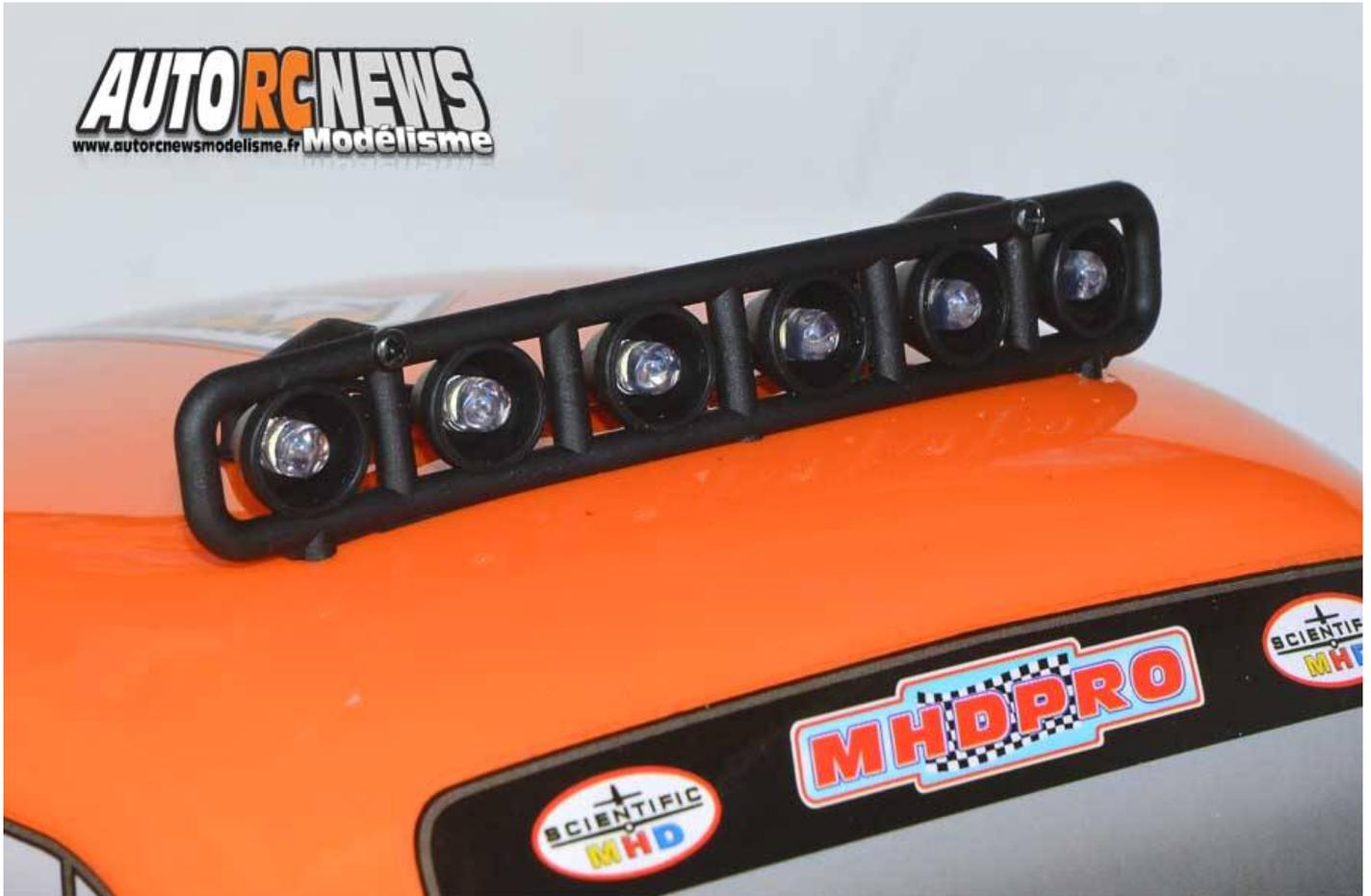
**La voiture est équipée d'une rampe de phares à led que l'on commande depuis l'émetteur.**
