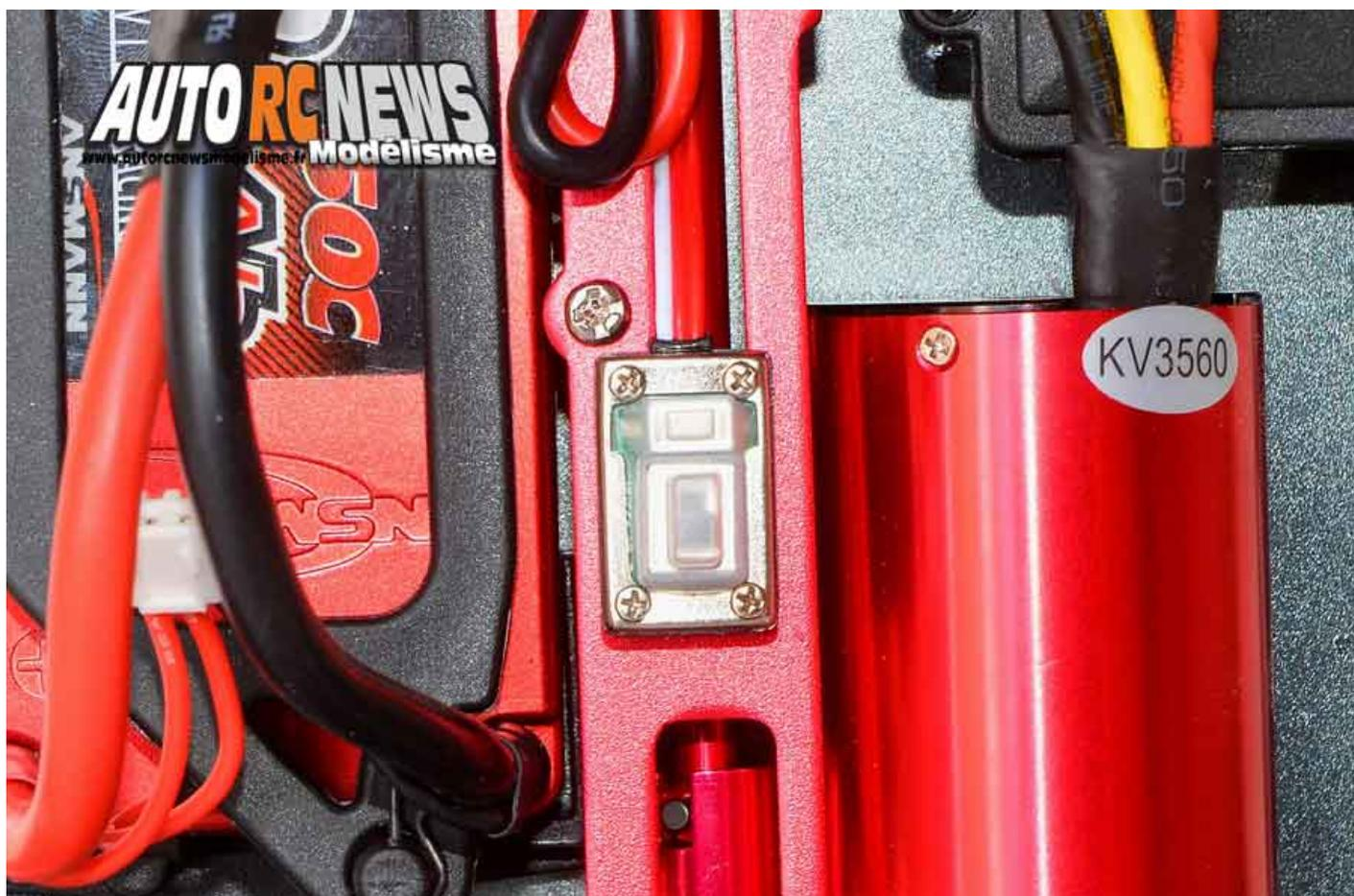
**Ce minuscule bouton poussoir placé à côté de l'interrupteur permet de modifier les caractéristiques de base du contrôleur.**
