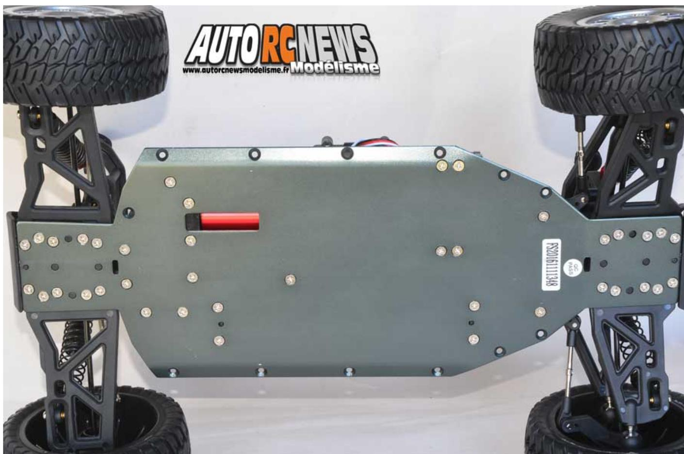
Le châssis de cette auto est un modèle en aluminium anodisé de 2,5 mm d'épaisseur à bords relevés.
