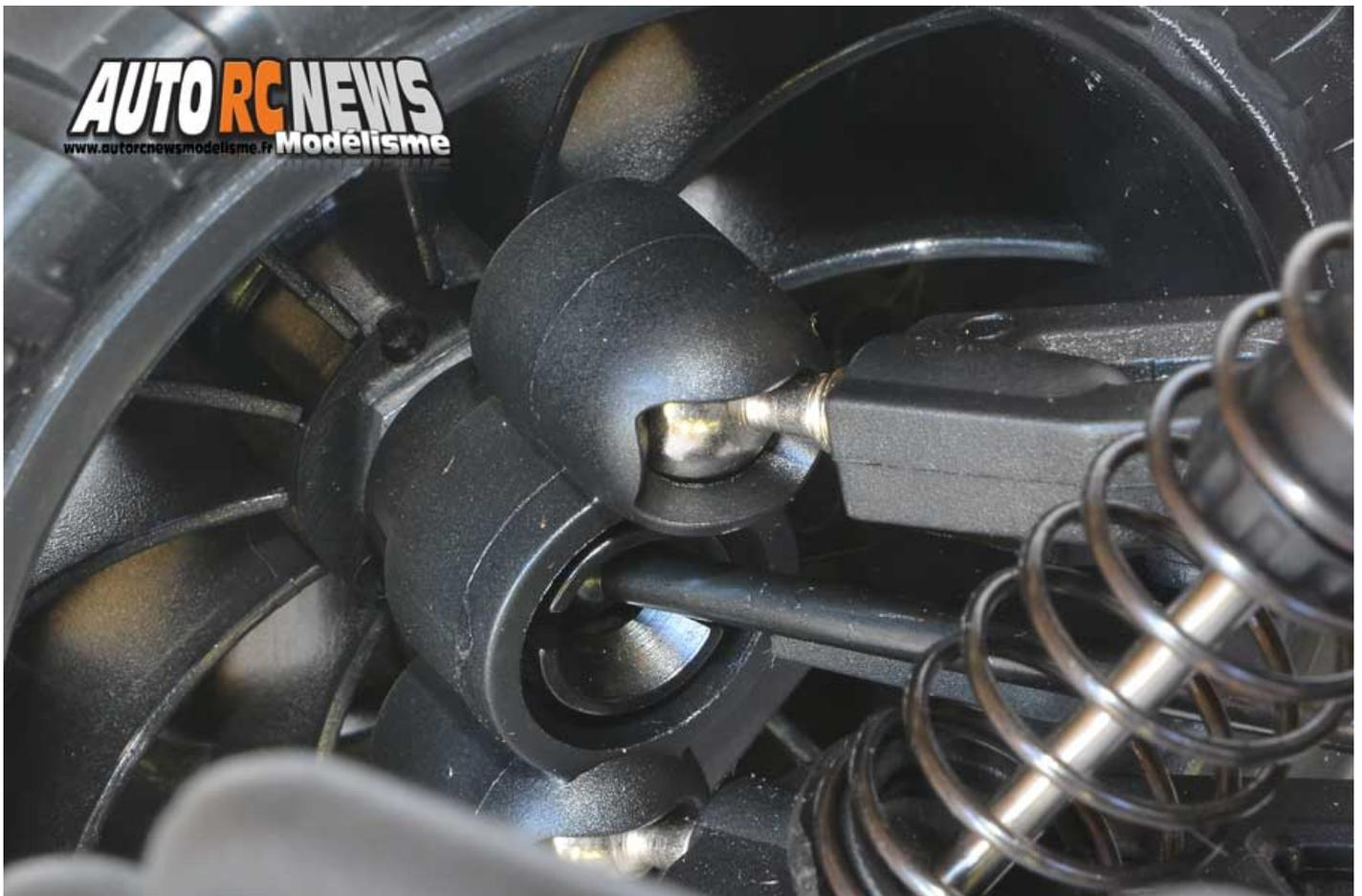
**La transmission avant repose sur des cardans droits à boules goupillées.**
