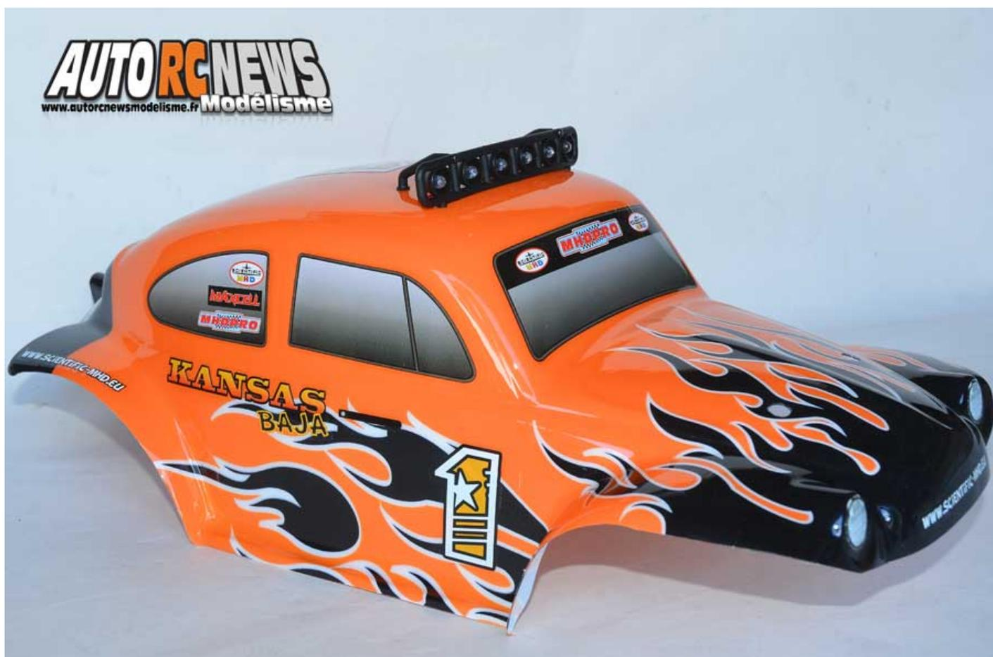
**La carrosserie peut être extraite du châssis. Il suffit de débrancher la prise qui relie ses phares au récepteur.**
