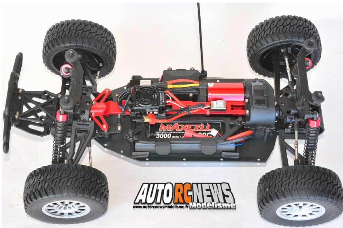
**La voiture à l'échelle 1/10ème possède des côtes généreuses comme un empattement de 305 mm, ainsi qu'une transmission 4 roues motrices.**
