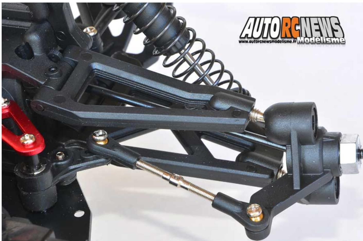
**La géométrie fait appel à des triangles sur la partie supérieure. Les biellettes de direction sont équipées de pas inversés.**
