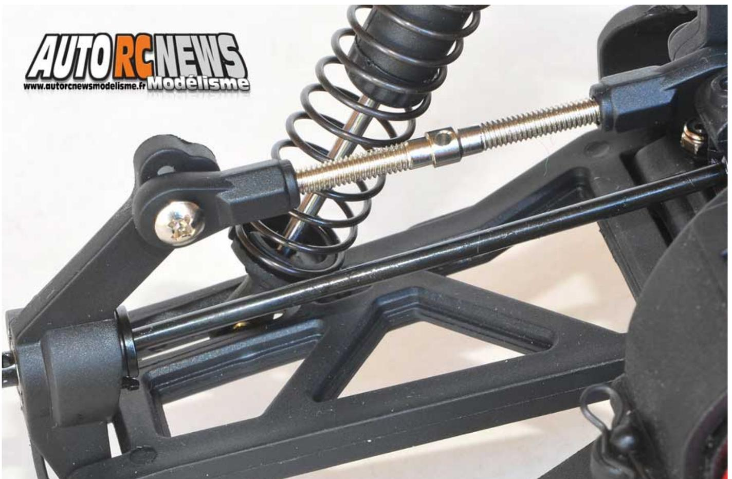
**La géométrie associe des triangles et des tirants montés sur rotules équipés de biellettes à pas inversés.**
