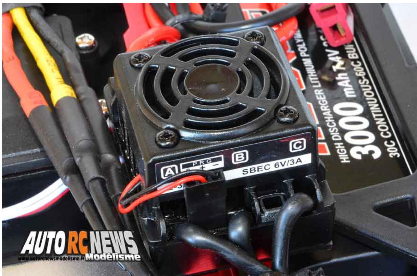
**Le nouveau contrôleur Hobbywing de 60 Ampères compatible Li-Po 2 et 3S pourra être programmé et possède un dispositif de protection thermique.**
