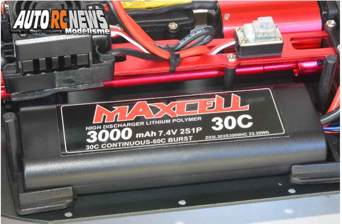
**La voiture est livrée avec son accu. En l'occurrence, s'agissant d'un accu Li-Po 2S Maxcell 7,4 volts de 3000 mA en 30C.**
