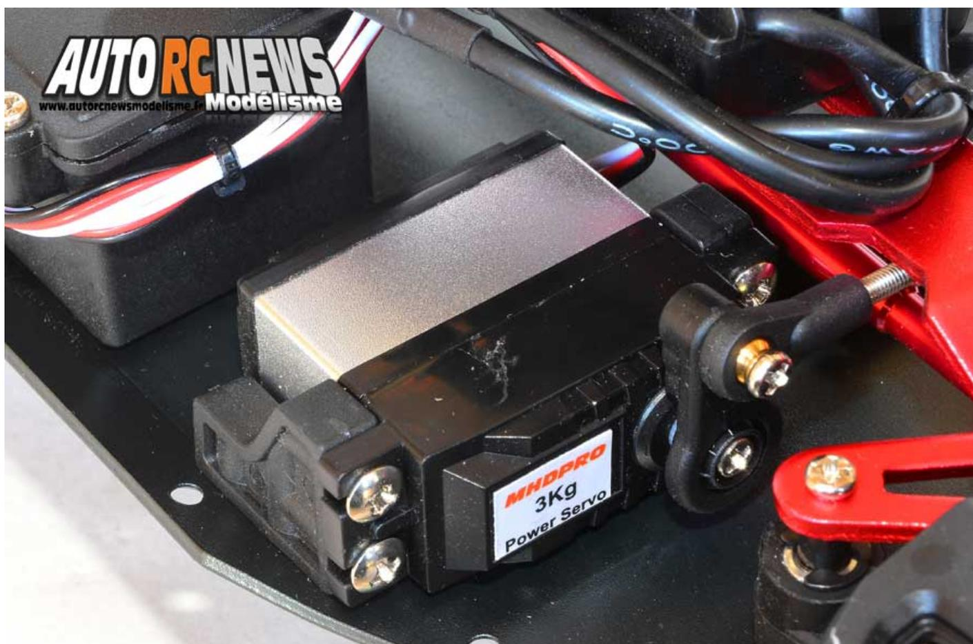
**Pour mouvoir les roues avant, le Kansas Baja reçoit un servo de 3 kilos de couple à pignons plastiques équipé d'un radiateur en aluminium.**
