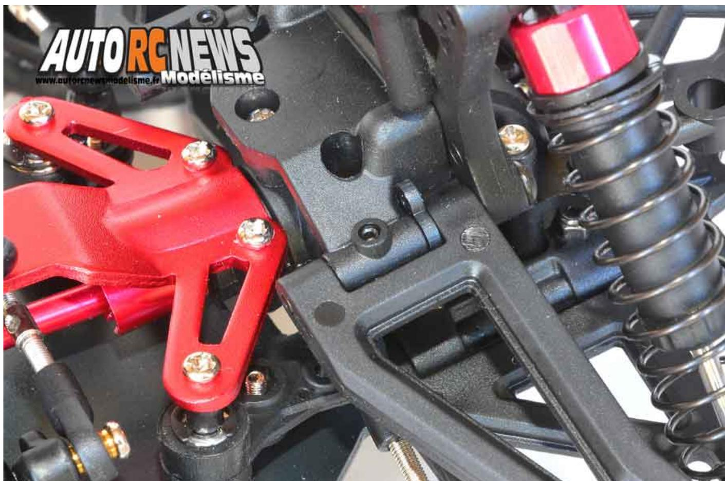
**A l'avant, cette petite cale permet d'ajuster l'angle de châsse de l'auto.**
